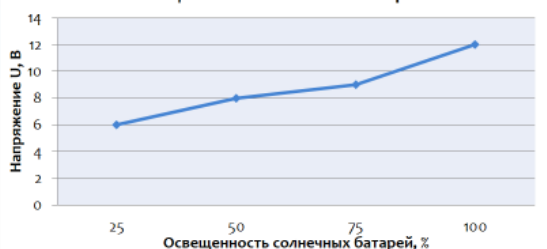
Зависимость напряжения от площади освещенности солнечной батареи
